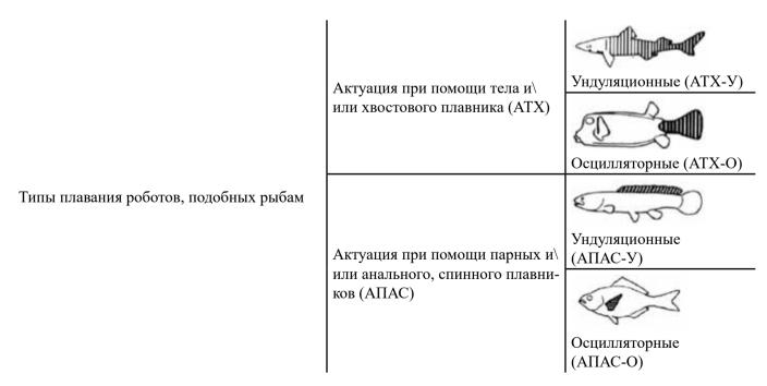
Puc. 3. Типы плавания роботов, подобных рыбам. Классификация, используемая в работах [12,17] (фрагмент, перевод)
