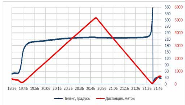
Рис. 4. Пеленг и дальность излучателя относительно донной станции в обоих галсах буксировки
