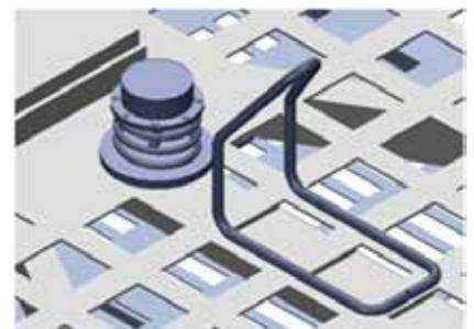
Рис. 14. Модель ЭМ на пружинном основании
