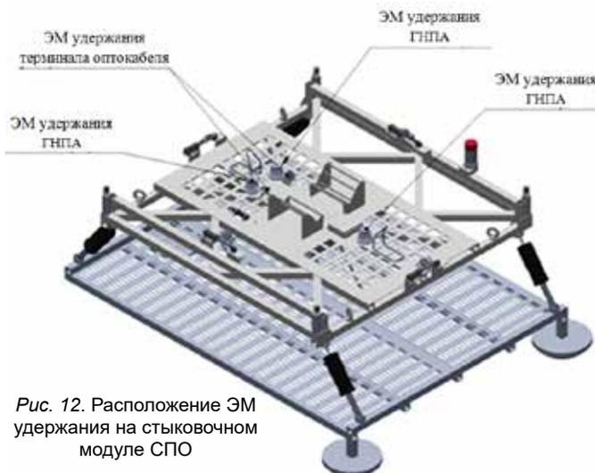
Рис. 12. Расположение ЭМ удержания на стыковочном модуле СПО
