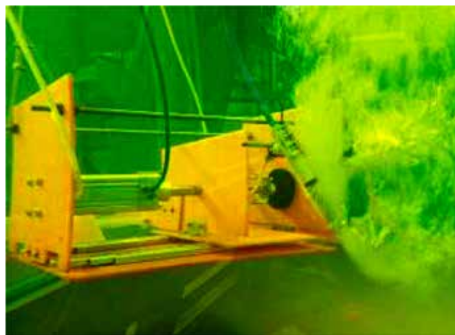
Рис. 8. Испытания на отрыв вакуумной присоски в водной среде
