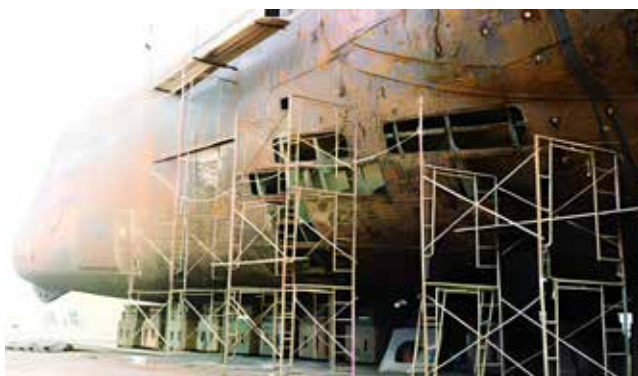
Рис. 1. Постановка кораблей и судов в сухой док для судоремонта
