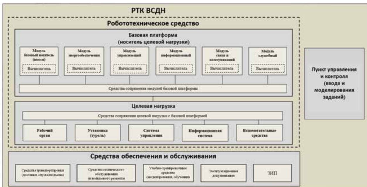
Рис. 6. Типовая схема деления (типовой состав) РТК
