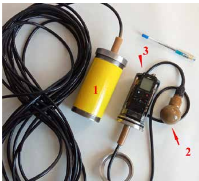
Рис. 2. Автономный гидроакустический регистратор: 1 – гермокорпус, 2 – гидрофон, 3 – диктофон, 4 – SD-карта и микроконтроллер
